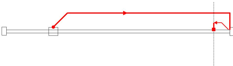
**方法-2:** 低速负向找原点，当转矩到达后反向，当转矩到达消失后的第一个 Z 信号时停止
