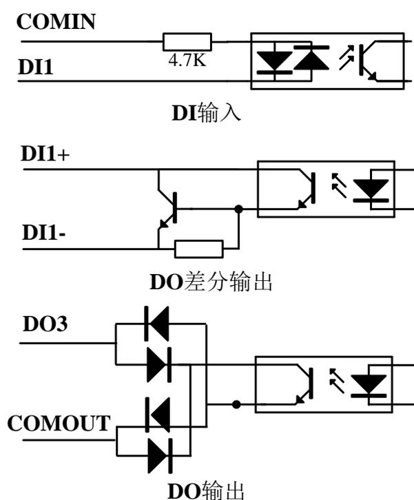
图 3-4 开关量输入/输出接口
