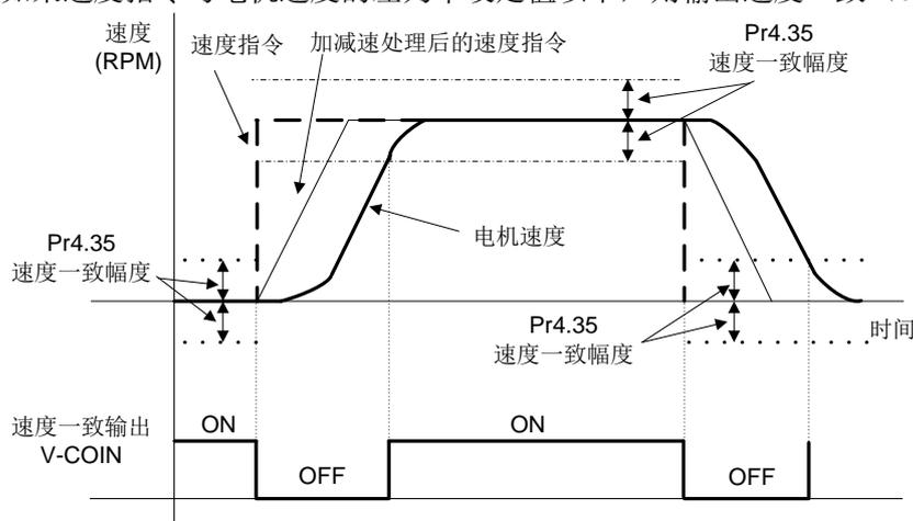
为了使用 10RPM 的磁滞，速度一致检测的实际检测幅度如下所示。
