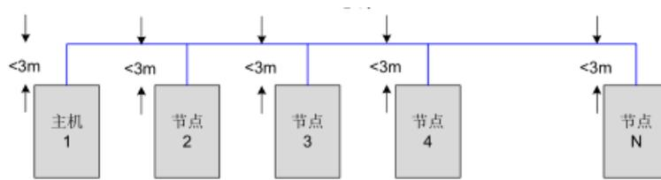
图 4 多台 CAN 驱动器组网结构图
