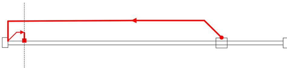
**方法-3:** 高速正向找原点，当转矩到达后反向，当转矩到达消失后立即停止。并经过 Pr5.37 设定的时间后输出回原点完成信号。
