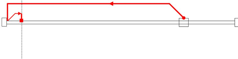
**方法-1:** 低速正向找原点，当转矩到达后反向，当转矩到达消失后的第一个 Z 信号时停止
