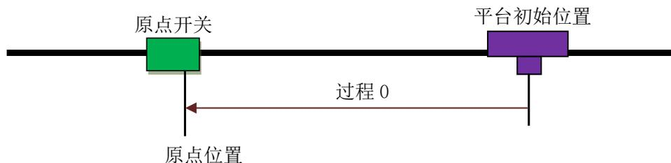
图 4.1 一次回零方式示意图
