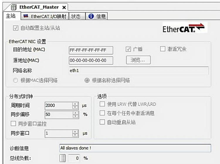
图 6.6 在线模式显示诊断信息
