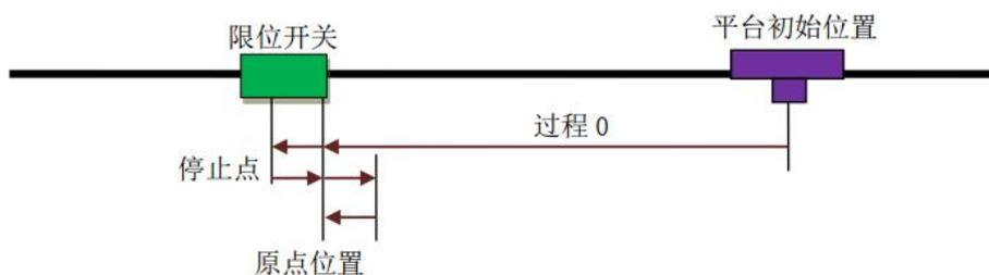
图 4.13 两次限位回零方式示意图
