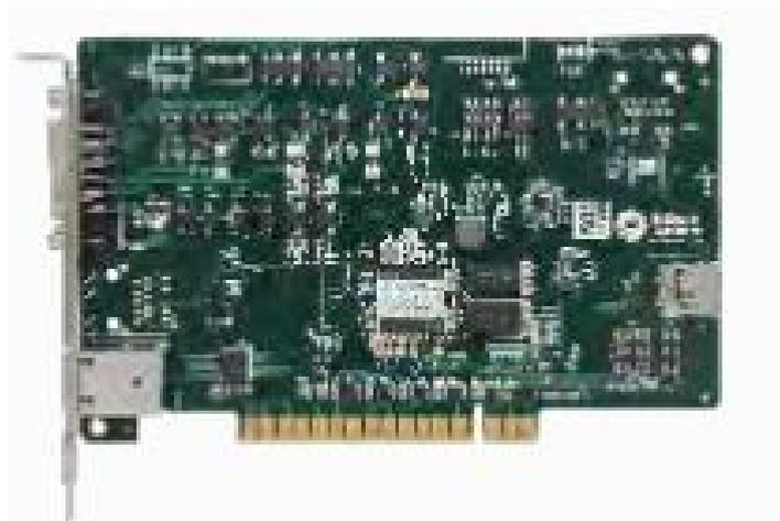
图 6.42 EtherCAT 总线运动控制卡外形
