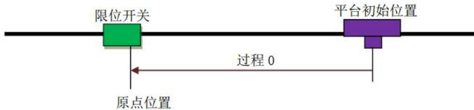
图 4.11 一次限位回零方式示意图
