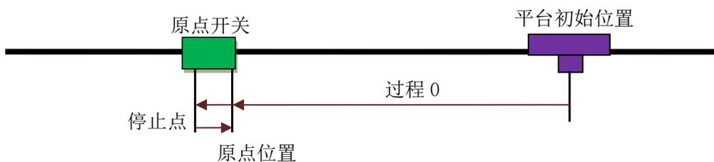
图 4.2 一次回零加回找方式示意图
