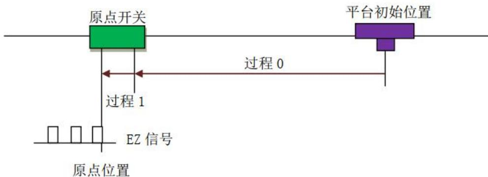
图 4.4 一次回零后再找 EZ 信号回零方式示意图
