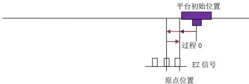
图 4.9 单独记一个 EZ 锁存回零方式示意图
