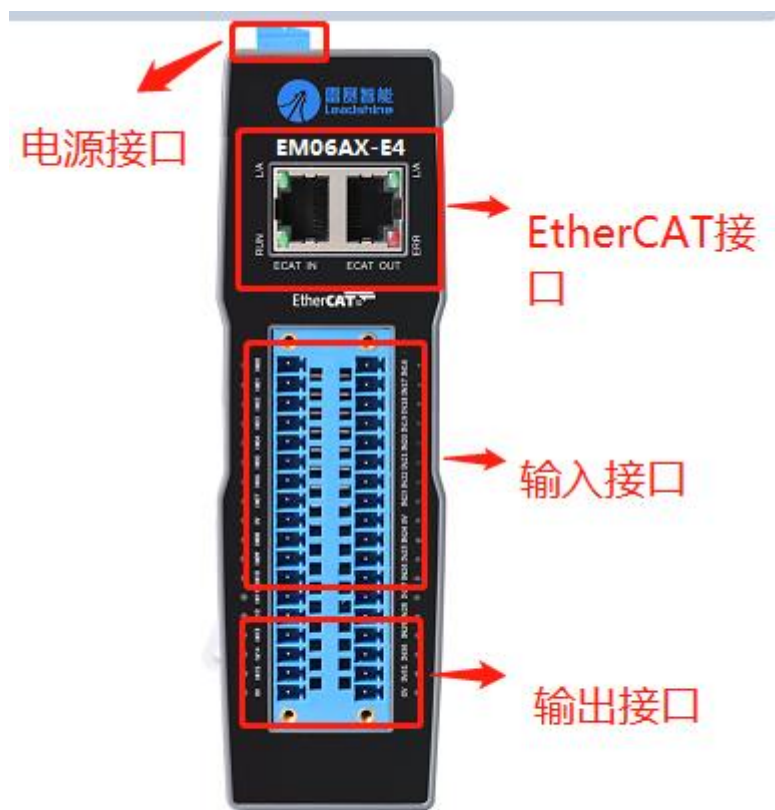
图 2.2 EM06AX-E4 模拟量扩展模块接口图
