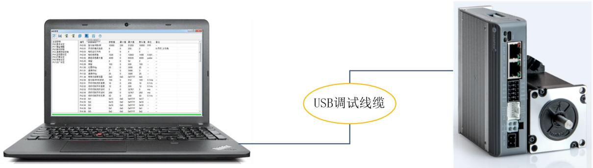
图 4-2 驱动器与 PC 的连接示意图
