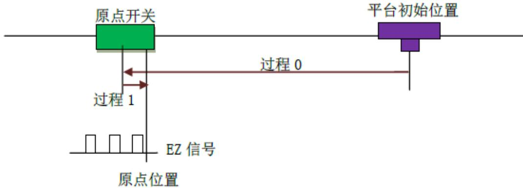
图 4-18 原点锁存加反向 EZ 锁存进行回零
