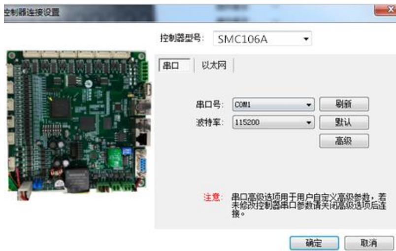
图5-5 串口方式参数设置
