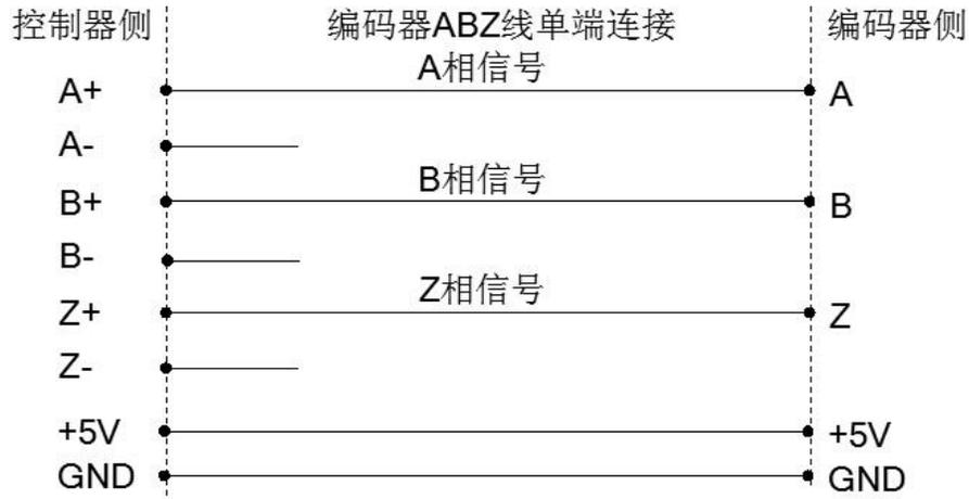
图 2-15 集电极开路输出编码器接口电路图
