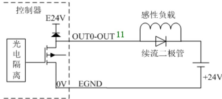
图 F1-3 SMC106A-BAS 控制器与电磁阀连接图
