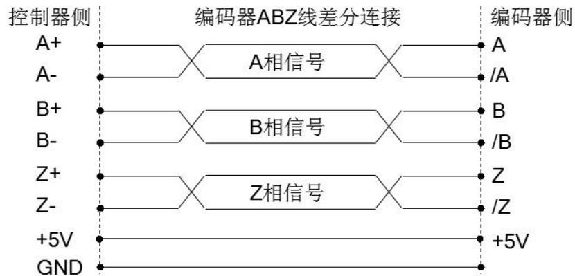
图 2-14 差分输出编码器接口电路图
