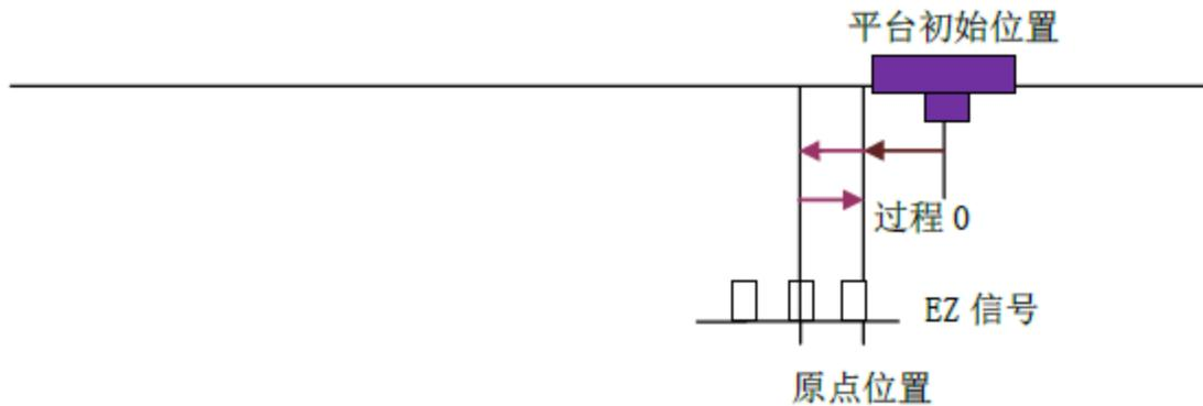
图 4-17 单独记一个 EZ 锁存回零方式示意图
