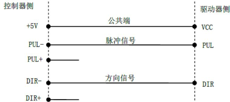
图 2-10 脉冲/方向单端输出电路
