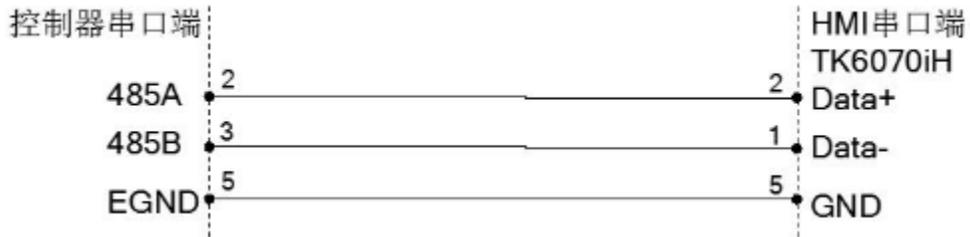
图 3-4 HMI 与控制器连接
