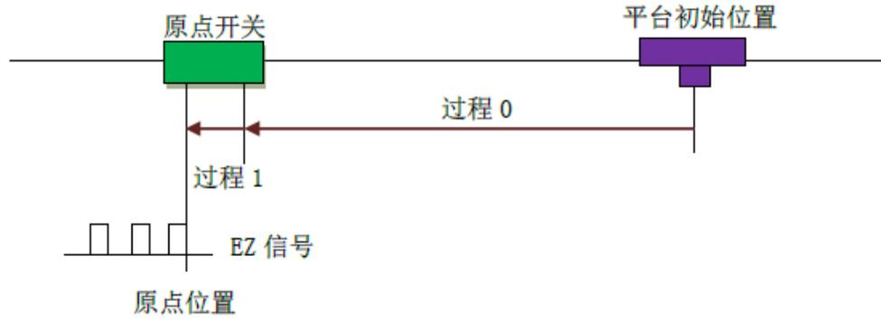
图 4-16 原点锁存加同向 EZ 锁存回零方式示意图
