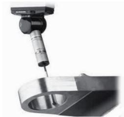
图 4-28 被测工件与探针示意图
