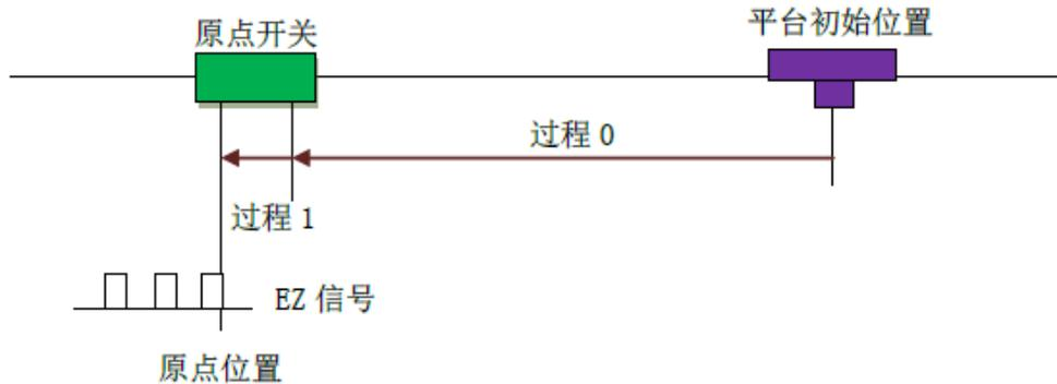
图 4-12 一次回零后再找 1 个 EZ 信号回零方式示意图
