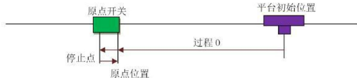
图 4-10 一次回零加回找方式示意图
