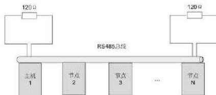
图 8-5 终端电阻的正确接入方式
