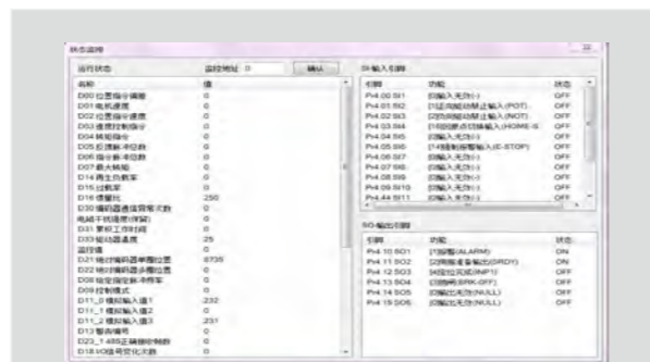
状态监控： 电机运行实时数据监控、IO监控，客户使用更方便；
