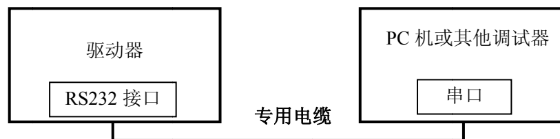
图 5 参数调试接线原理图
