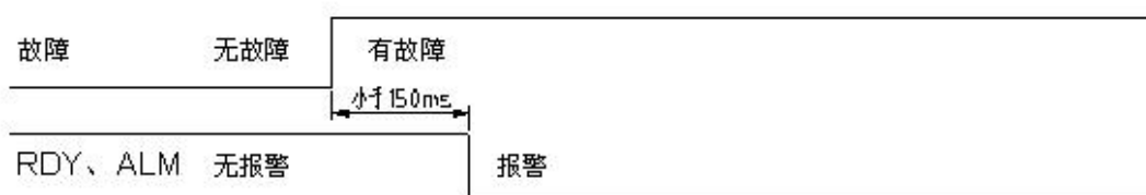
图 7-2 驱动器报警时序图
