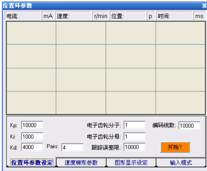
图 3 电机极对数和编码器线数
